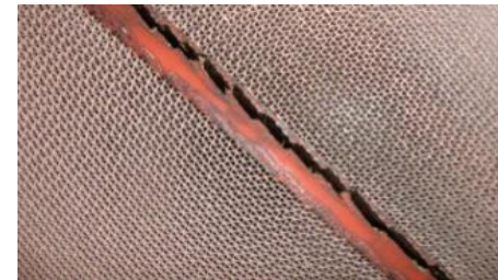
氣密材裂縫造成短流
