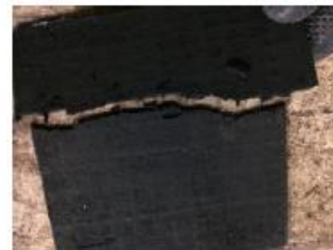
電池極板材料劣化
