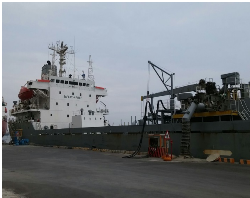
亞泥三號 高雄港 岸電卸貨
