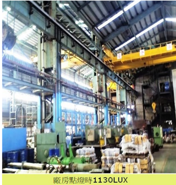
圖 53. 中鋼機械 B 廠房結合自然光與人造光源照片
