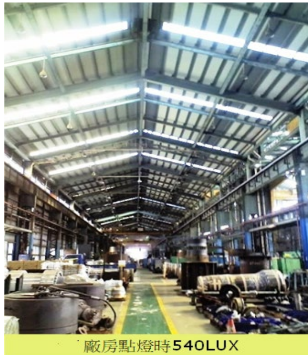
圖 52. 中鋼機械 A 廠房結合自然光與人造光源照片
