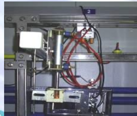
8. 小便斗沖水器測試設備
