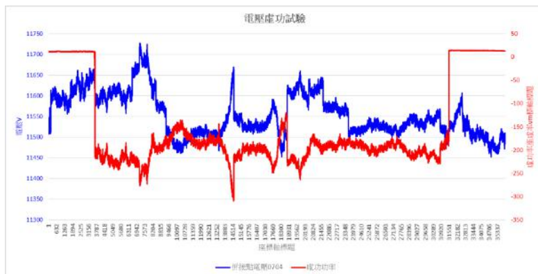
電壓/虛功(Volt-Var)自主調控
