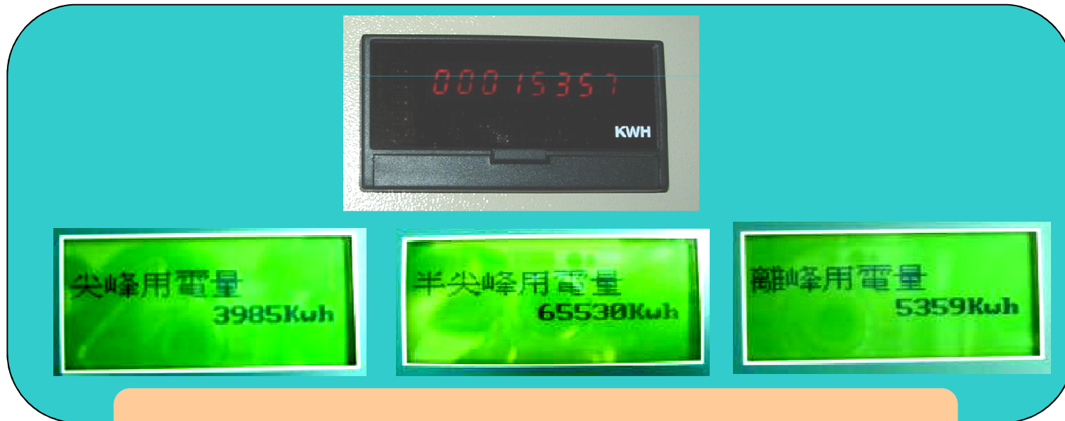
掛錶記錄熱泵在各用電時段之耗電量
