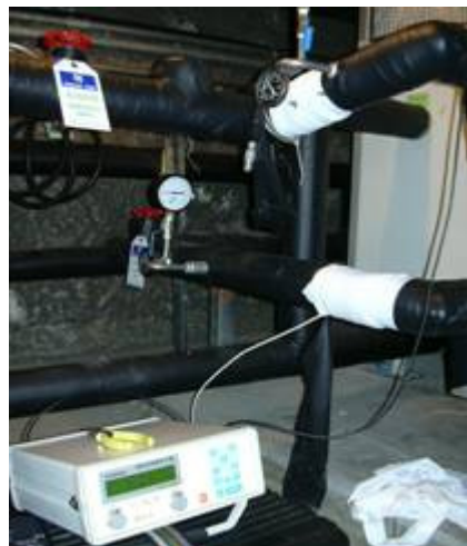
熱泵進出水溫量測
