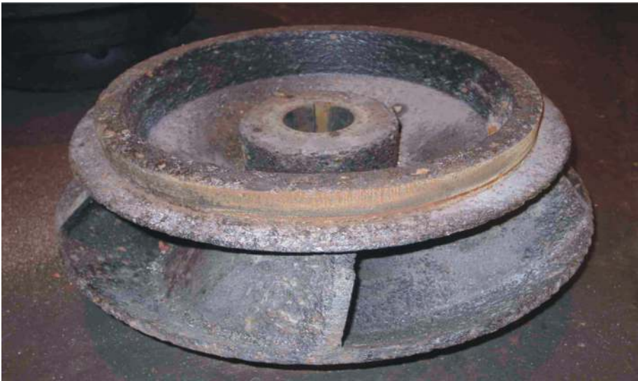
圖42 碳鋼葉輪運轉4~20年，效率下跌20%大修後仍持續使用中
