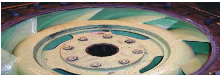
圖47 木頭卡在擴散器已重新油漆
