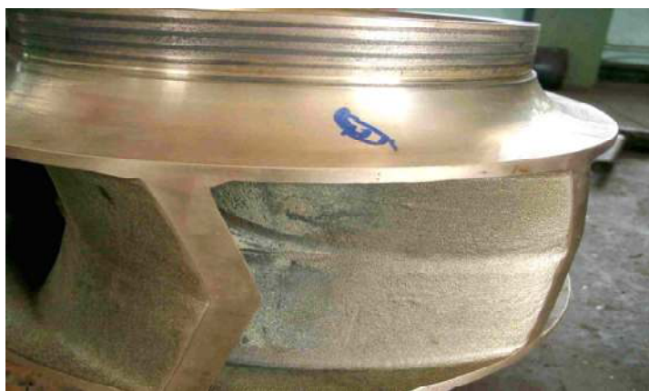
圖48 水平雙吸式泵浦磨損環的管理很重要
