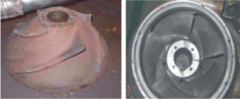
圖45 有鐵砂、木頭時要反應至運轉體系，追查系統流程的改善
