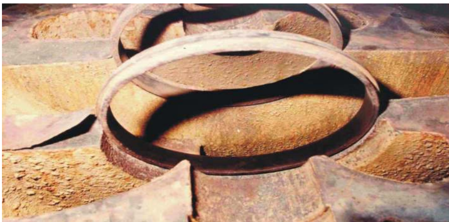
圖39 泵殼內部生銹形成的粗糙度也影響效率
