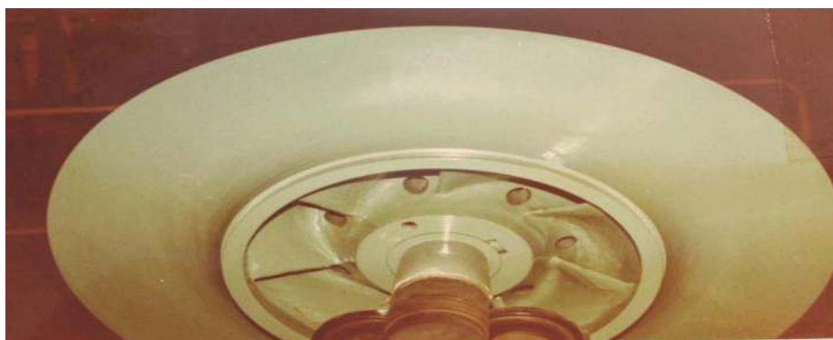
圖27 國外及中鋼公司早期碳鋼葉輪實施COATING
