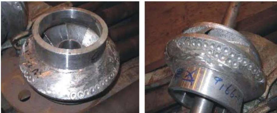
圖38 葉輪鑄造水準不佳，動平衡不宜做在表面
