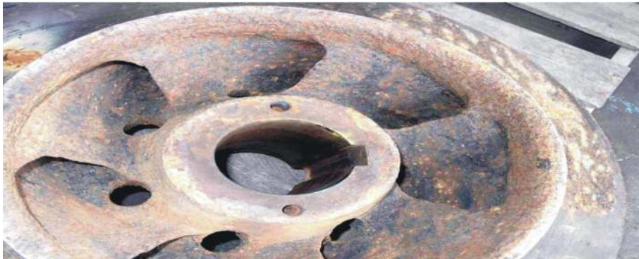
圖36 無coating碳鋼葉輪，運轉4~20年仍然繼續使用
