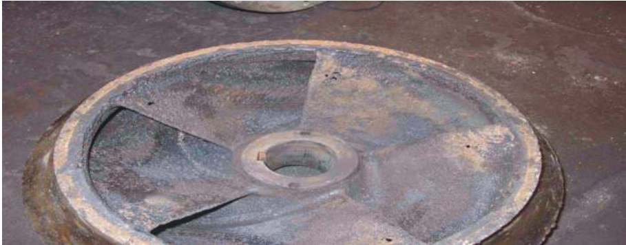
圖37 運轉20年，葉片銹蝕穿孔嚴重
