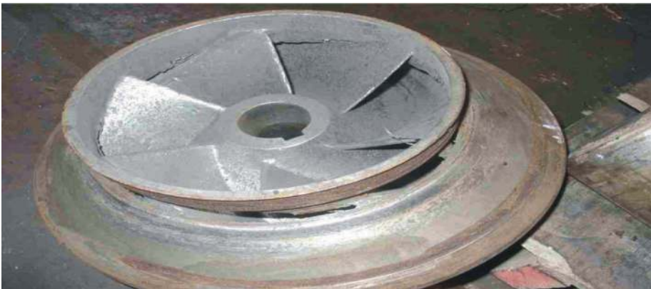
圖46 有砂石未及時改善，會反覆發生葉輪破裂問題
