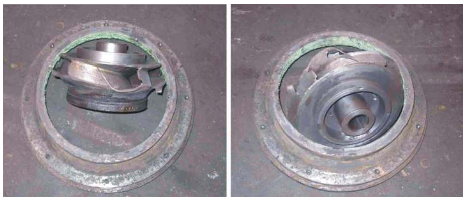
圖43 有scale時要反應至運轉體系，追查系統流程問題
