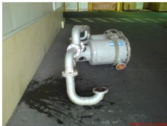
圖七、舊空氣精密過濾器
