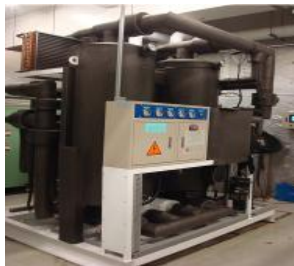
圖3、改善後熱回收吸附式乾燥機
