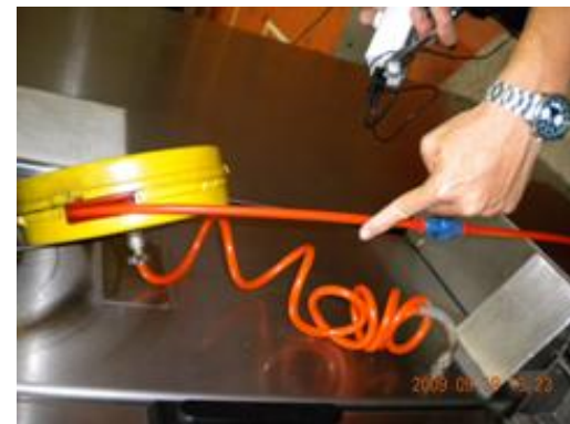
圖十九、充填機空氣槍軟管破裂
