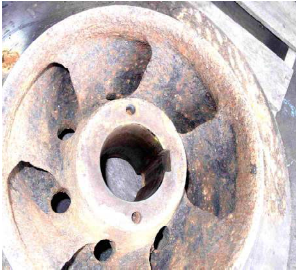
圖59 粗糙葉輪與磨損環間隙影響效損定量資料
