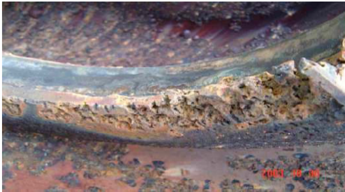
圖50 變速不當造成的泵殼損壞
