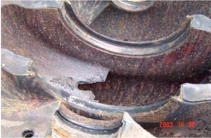
圖49 變速不當造成的泵殼損壞
