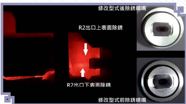
▲粗軋區除銹噴嘴型式修正減少噴水量
