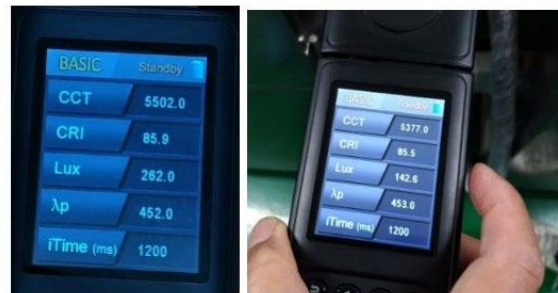
圖4-4 2F生產區工作台照度262 lux及走道照度142.6 lux
