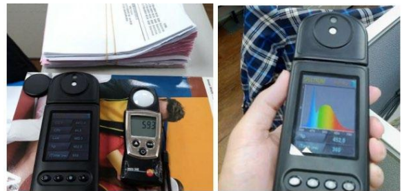
圖4-3 1F辦公室照度約600lux(符合CNS推薦標準500-700lux) 及LED平板燈光譜
