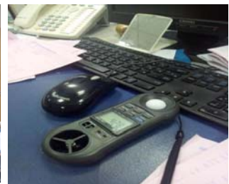
照度計量測現場更換LED燈管後照度
