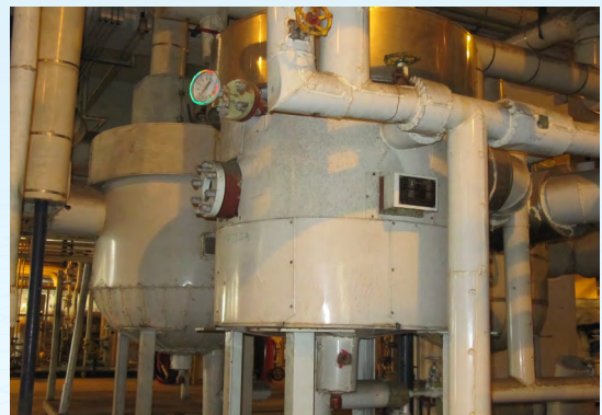
▲ 押出機真空排氣罐蒸汽加熱改冷卻水降溫
