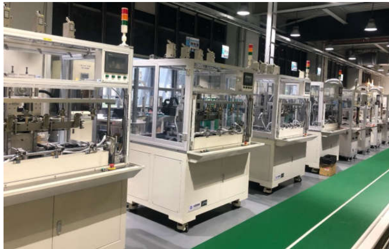
高效率外轉子BLDC馬達定子自動化產線
