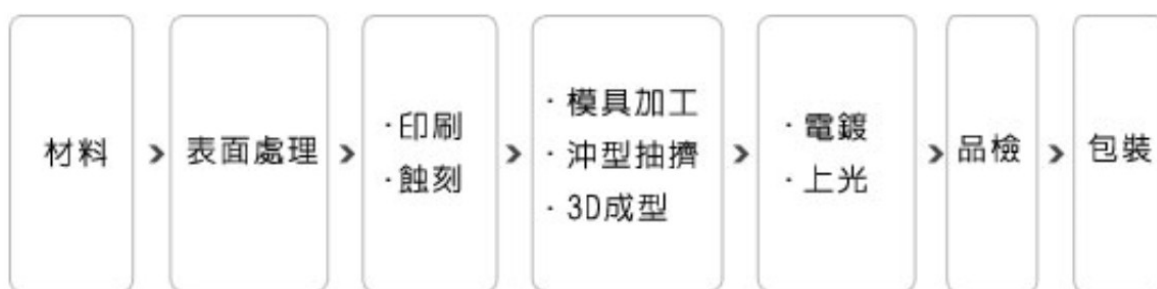
圖 40 案例 B 廠製造流程圖
