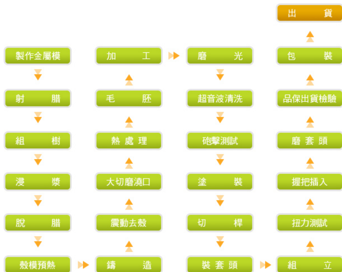
■ 圖 2 高爾夫球桿製造流程圖
