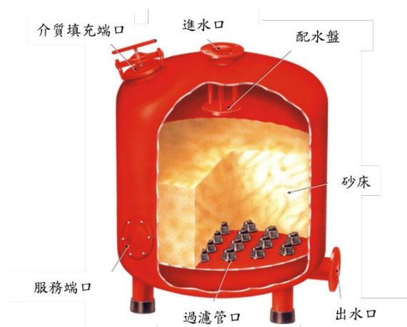
■ 圖 12 砂濾過濾系統設備圖
