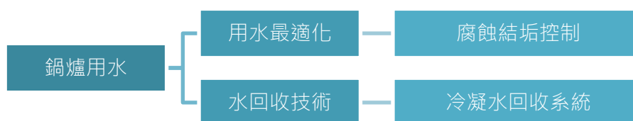
圖 26 鍋爐用水最適化及水回收技術
