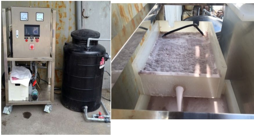
圖 31 電混凝處理系統設備圖
