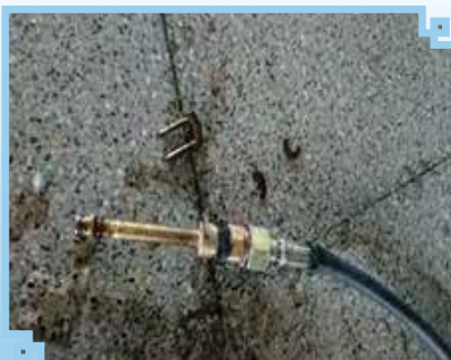
▲ 更換前 ( 高壓清洗機噴槍槍把漏水 )
