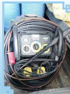
▲ 更換後 ( 高壓清洗機水管磨損滲水 )
