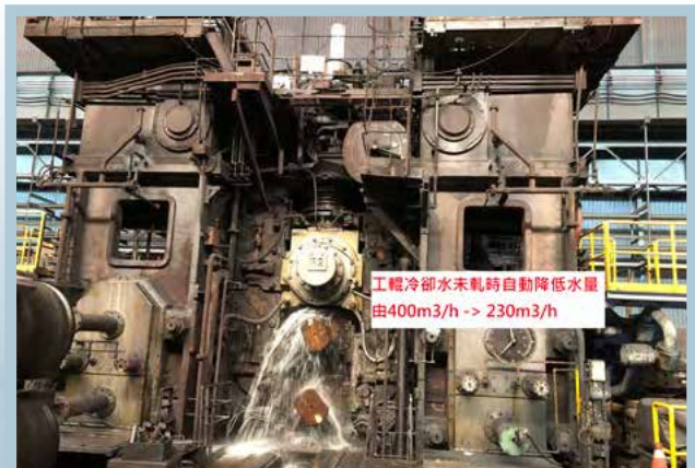
▲粗軋機工軋冷卻水自動降低水量
