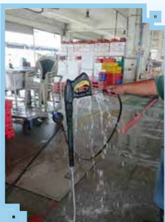
▲ 更換前 ( 高壓清洗機噴槍槍把漏水 )
