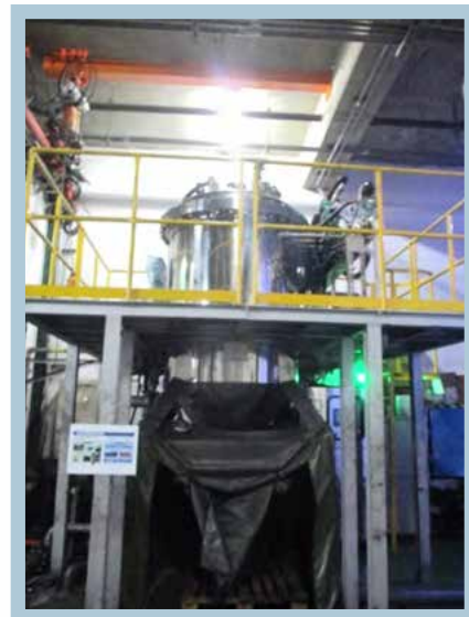
▲ UF 回收系統濃排廢水回收再利用
