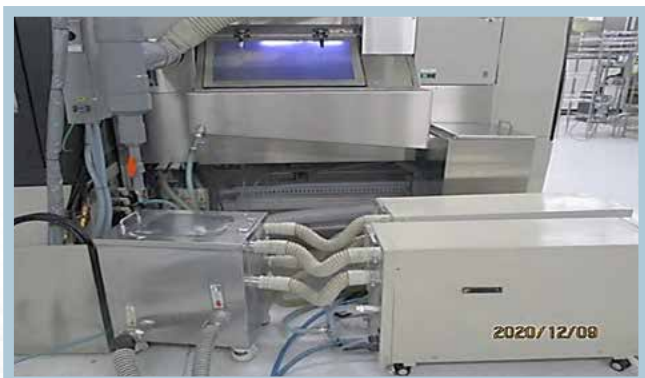
▲產線後段清洗機真空泵 DI 用水改回收水
