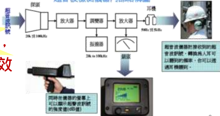
超音波檢測儀器內部結構圖
